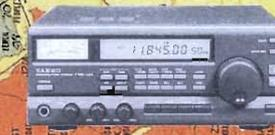
**TRG 100** Ricetrasmittitore multibanda HF da 50 KHz a 30 MHz Alta sensibilità e doppia conversione in SSB AM FM.
